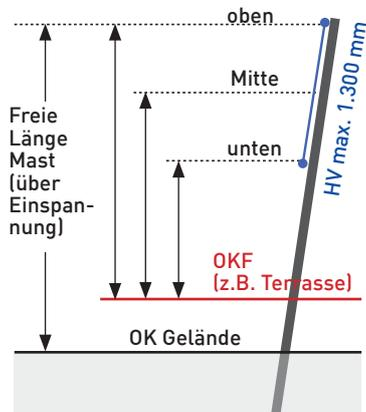
Die Angabe von Höhen (über OKF) ist relevant für die Segelkonstruktion. Segel werden auf die mittlere Position konstruiert. Die Messwerte für oben und unten sind erforderlich für die Festlegung von Abmaßen und die Einschätzung zur Erreichbarkeit der Positionen. Zudem werden Zuschnittskompensationen und Regenwasserablauf darüber definiert.
